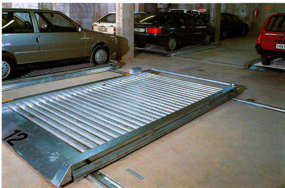
Die neue querverschiebbare Parkplatte P501 für flächensparendes Parken
