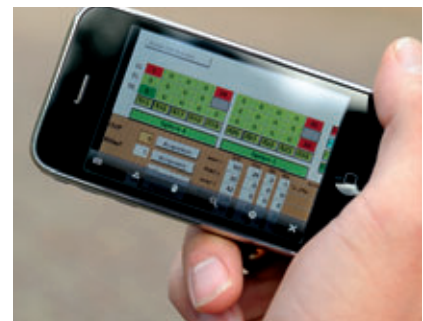
15 Für einen schnellen Kundendienst können geschulte Servicetechniker über eine gesicherte Internetverbindung direkt auf die Systemsteuerung zugreifen. To ensure a fast customer service, trained service technicians can access the system control directly via a secure internet connection.
