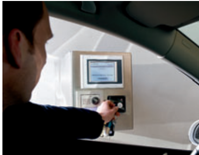
Er hält seinen Park-Chip an das Lesegerät. Der Leitrechner prüft, ob freie Stellplätze verfügbar und bereits Parkvorgänge aktiviert sind. Der nächste freie Stellplatz Nr. 54 an Tor Nr. 6 wird angezeigt. He holds his parking chip to the operating device. The master computer checks if free spaces are available and parking processes have already been activated. The next free space gate 6 space 54 is displayed.
